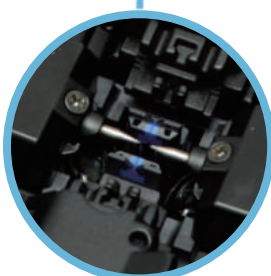
Czas spawania: 4 s Żywotność elektrod: ponad 5 500 łuków
